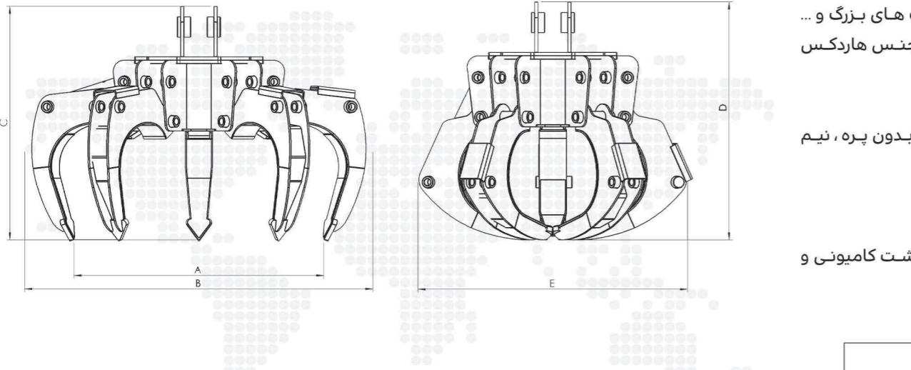
جابجایی انواع ضایعات فلزی و غیرفلزی مانند کاغذ، سنگ های بزرگ و ... ساخته شده از بهترین مواد اولیه همراه با ناخن هایی از جنس هاردکس و قابل تعویض سفارشی سازی بر اساس نیاز مشتری قابل سفارش به صورت ۴,۵ و ۶ پره و همچنین به صورت بدون پره، نیم پره و یا پره کامل امکان نصب آهنربای الکترومغناطیسی قابلیت نصب سیستم گردان قابل نصب بر روی بیل مکانیکی، انواع جرثقیل سقفی و پشت کامیون و بیل بکهو
